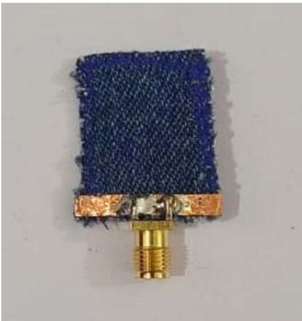
(d) Bottom View of fabricated Dual H shape antenna
